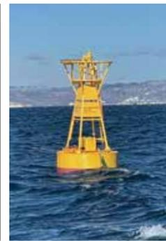
白糠町では、可視化調査で得られたデータをもとに、海水温や塩分濃度、溶存酸素量を計測するセンサーを設置しています。このデータはリアルタイムで確認することができ、漁師は陸地からスマホでデータを確認し、魚に出る判断材料にしています。効率的かつ無駄なガソリンを使うことなく二酸化炭素(CO<sub>2</sub>)を排出しない、環境にも優しい漁業のDX化を図っています。
