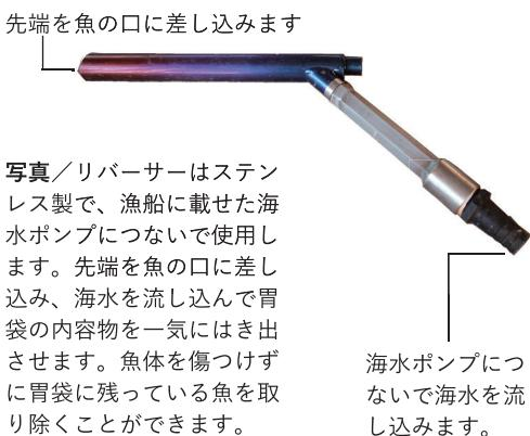
写真／リバーサーはステンレス製で、漁船に載せた海水ポンプにつないで使用します。先端を魚の口に差し込み、海水を流し込んで胃袋の内容物を一気にはき出させます。魚体を傷つけずに胃袋に残っている魚を取り除くことができます。
