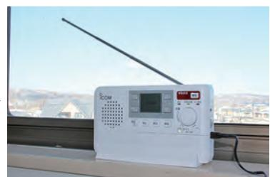
※アンテナは付属品ですので、取扱説明書に従って取り付けてください。平常時は乾電池を入れた上で、コンセントにつないで使用してください。乾電池は停電時に動かすための電源です。
