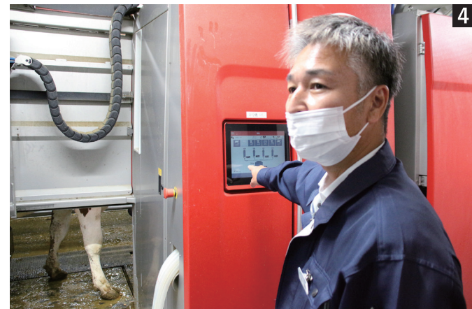
1/搾乳ロボット。牛の耳にはタグが付いており、そのタグを搾乳ロボットが自動で読み取り、固体の識別をしています。2/搾乳の流れで餌が出てくる仕組みになっており、餌を欲しさに牛はロボットに入室してきます。前回の搾乳から十分な時間が経過していない場合は、前のゲートが閉まらずに餌も出てこないため、そのまま牛舎へ出ていきます。3/乳頭に1本ずつミルカーと呼ばれる機械が装着され、搾乳します。乳頭位置はレーザーで検知されます。4/あとどれくらい搾乳できるかといった情報が、搾乳ロボットの画面に表示されます。
