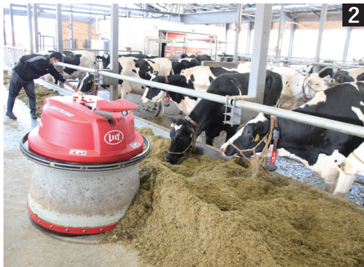
1/牛は1頭あたり1日平均50kgの餌を食べます。2/餌を寄せる作業ロボット。昼夜を問わず、自動化することで、餌寄せの頻度を増やすことができます。牛の飼料採取量が多くなることから生産性が高くなります。
