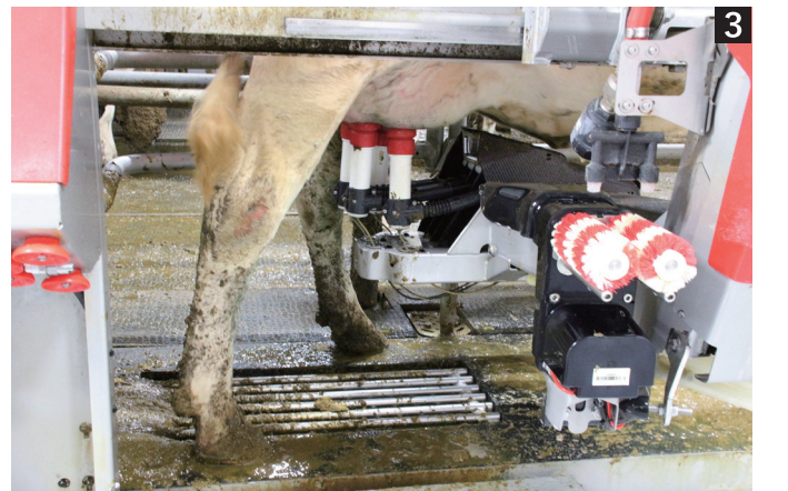
1/搾乳ロボット。牛の耳にはタグが付いており、そのタグを搾乳ロボットが自動で読み取り、固体の識別をしています。2/搾乳の流れで餌が出てくる仕組みになっており、餌を欲しさに牛はロボットに入室してきます。前回の搾乳から十分な時間が経過していない場合は、前のゲートが閉まらずに餌も出てこないため、そのまま牛舎へ出ていきます。3/乳頭に1本ずつミルカーと呼ばれる機械が装着され、搾乳します。乳頭位置はレーザーで検知されます。4/あとどれくらい搾乳できるかといった情報が、搾乳ロボットの画面に表示されます。
