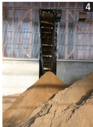
3/子牛のミルクやり体験をする生徒たち。 4・5/分離された固形の糞。臭いはなく、サラサラとした手触りで、牛の敷きわらや畑の肥料として使われています。
