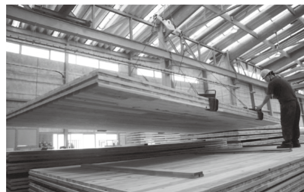
スギのCLTパネル
